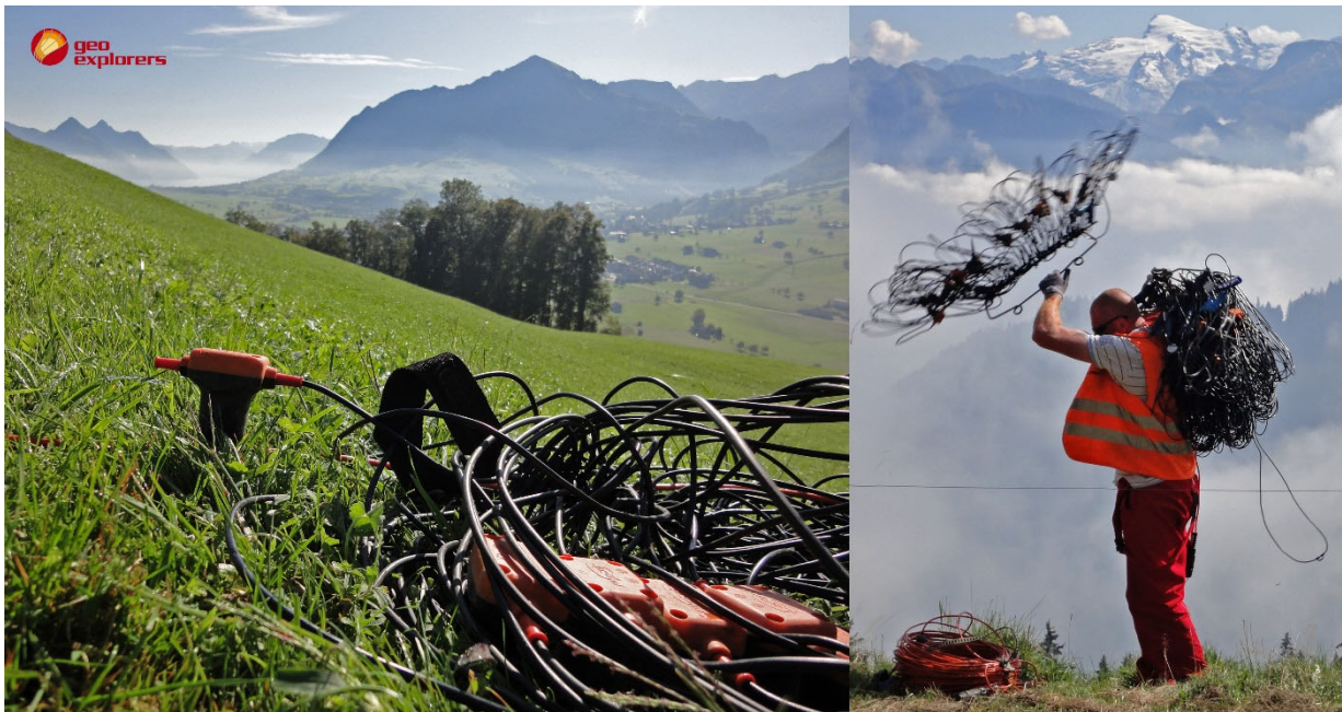
Abbildung 11: Auslegen der Geophone in Nidwalden
